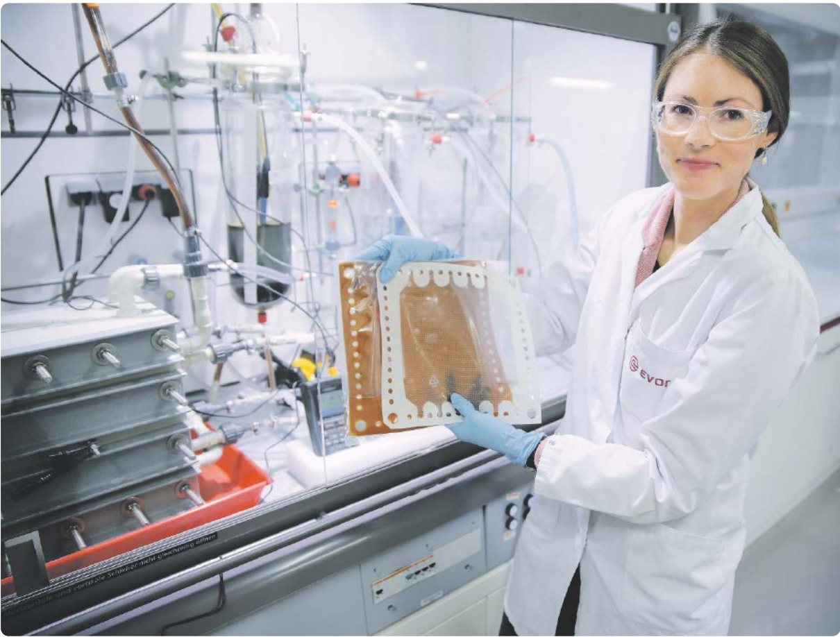
Prozessentwicklerin Blank-Shim zeigt die bipolare Membran (braun) und einen Spacer (weiß), der den Abstand zwischen den Membranen hält und durch den die Flüssigkeiten fließen.
