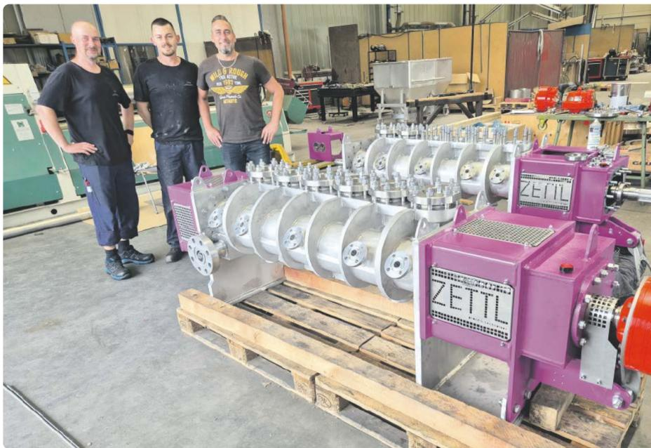
Doppelwellenmischer nach abgeschlossener Funktionsprüfung
