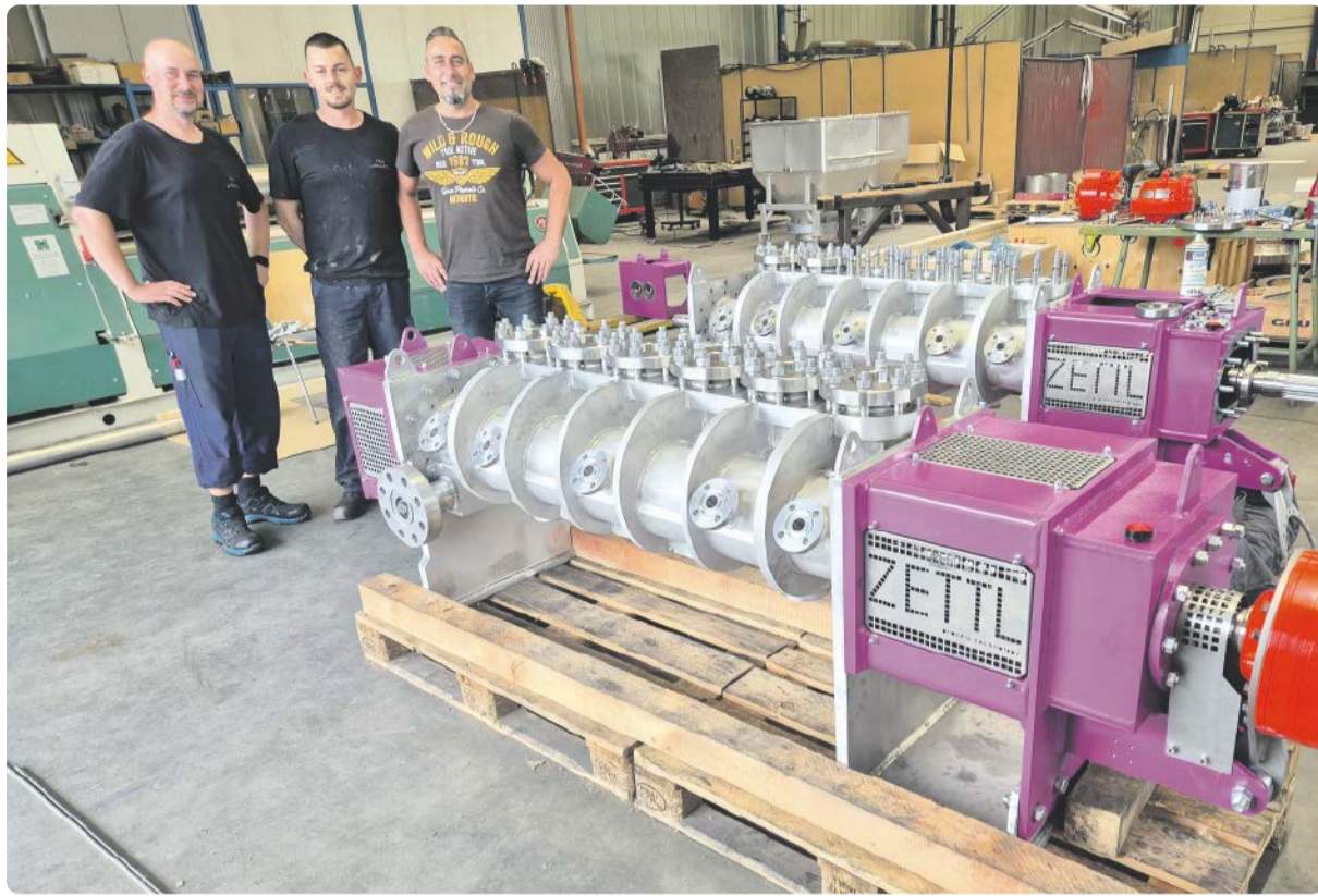
Doppelwellenmischer nach abgeschlossener Funktionsprüfung
