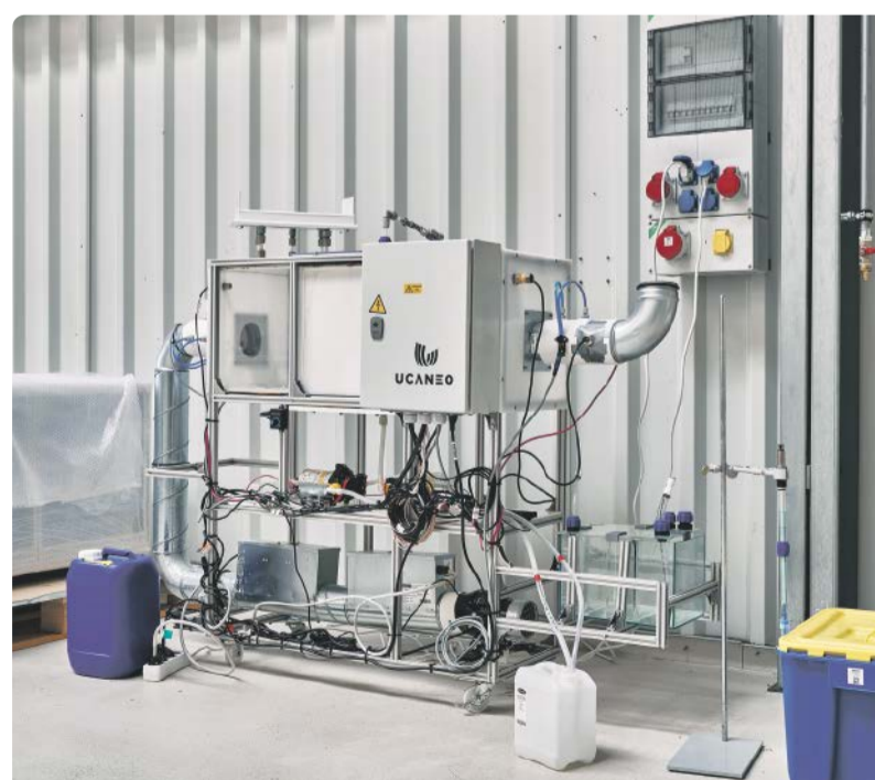
Ucano kombiniert in seiner Direct-Air-Capture (DAC)-Technologie einen Luft-Flüssigkeits-Kontaktor mit Elektrodialyse und biomimetischen katalytischen Additiven, um CO 2 effizient aus der Atmosphäre zu entnehmen.
