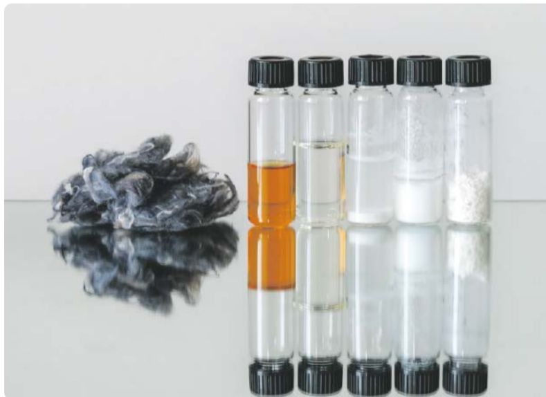
Der Re.resolution-Prozess (v.l.n.r.): Vom geschredderten Textil zum Hydrolysat und nach anschließender Entfärbung und Aufarbeitung zu kristallisierter Terephthalsäure.
