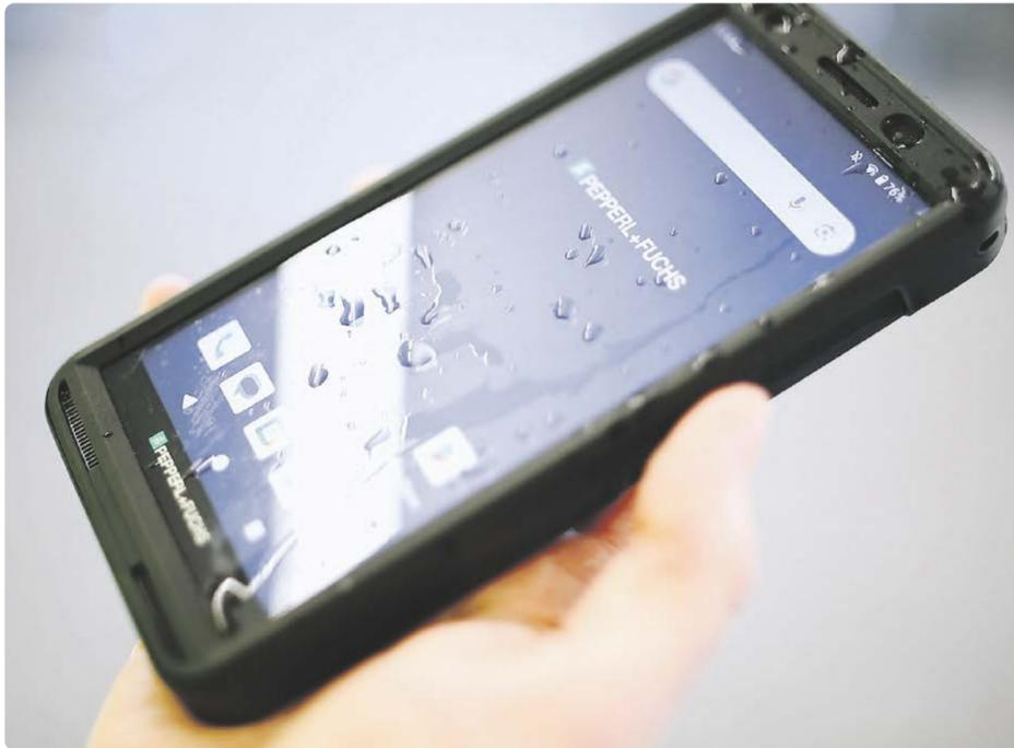
Das Smart-Ex 03 von Pepperl+Fuchs ist das einzige eigensichere Smartphone auf dem Markt, das mittels Fingerprint-Sensor entsperrt werden kann.
