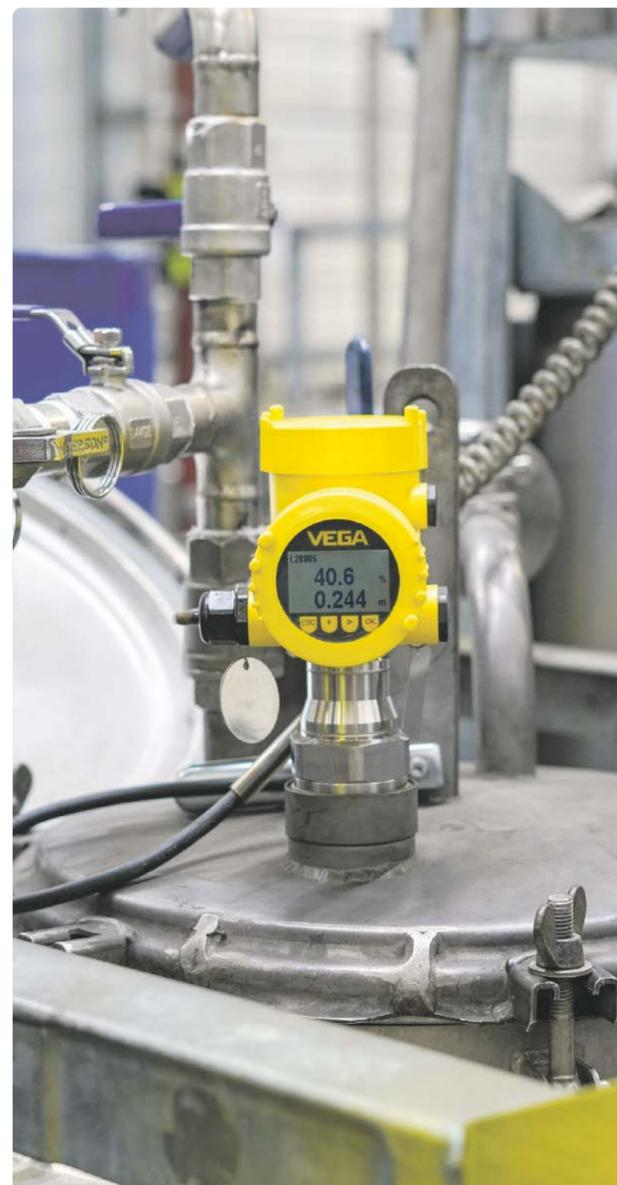
Hochgenau überwachen Radarsensoren Vegapuls 6X die Füllstände an mobilen Lagertanks bei Röhm, in denen Reststoffe aus der MMA-Produktion gesammelt werden. Selbst kleinste Prozessabweichungen müssen hier zuverlässig vermieden werden, damit die Produktqualität stimmt.
