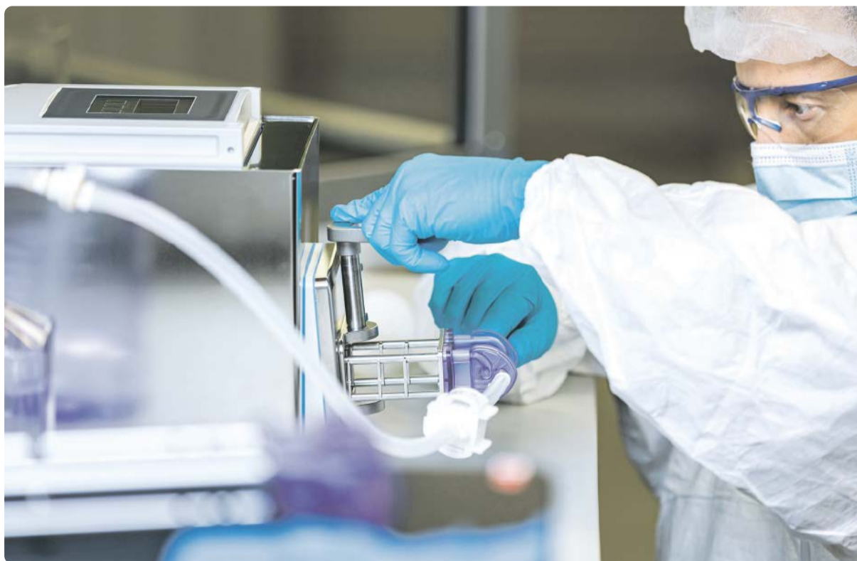
Proline Promass U 500 von Endress+Hauser ist das erste cGMP-konforme Coriolis-Durchflussmessgerät für die Biotechnologie. Die Einwegkomponenten können einhändig in die Basiseinheit eingeschoben und verriegelt werden. Die Handgriffe lassen sich auch mit angelegter Schutzkleidung einfach ausführen.
