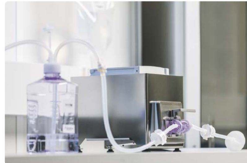
Proline Promass U 500 ist nicht nur als Einbau-Ausführung, sondern auch als Tabletop-Version in einem eigenen Gehäuse für flexibel einsetzbare Laboranwendungen verfügbar.
