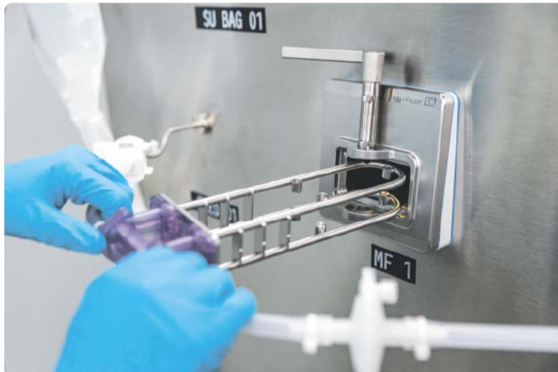
Die Einwegkomponente von Proline Promass U 500 wird in die Basiseinheit der OEM-Version eingeschoben.
