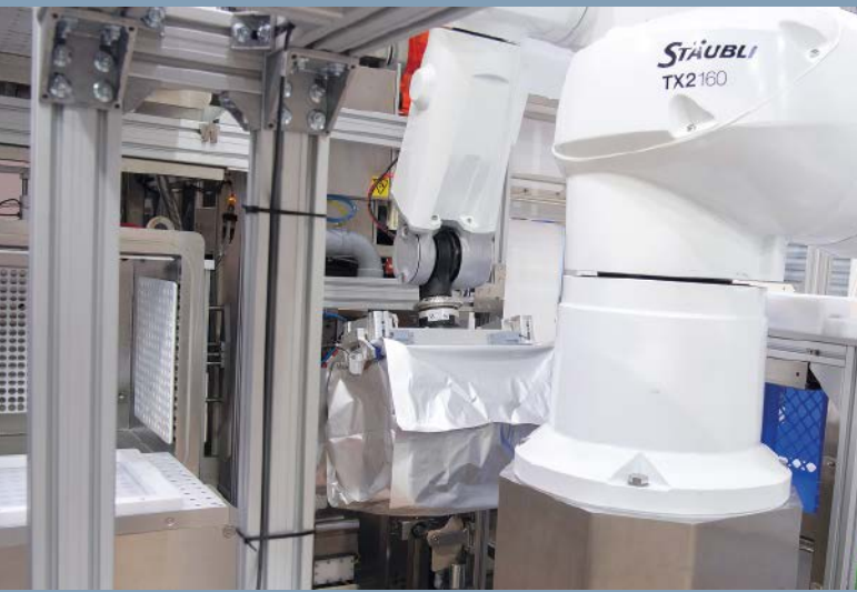
▲ Abb. 1: Zwei Staubli Sechssachsroboter vom Typ TX2-160 übernehmen sämtliche Handhabungsprozesse bei der FOSB-Verpackung.
