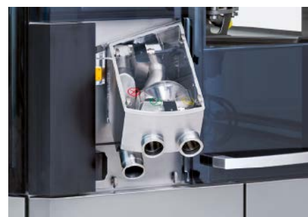
Ein Multiformatablauf sorgt für minimale Reibung und verhindert etwaige Materialstaus.
