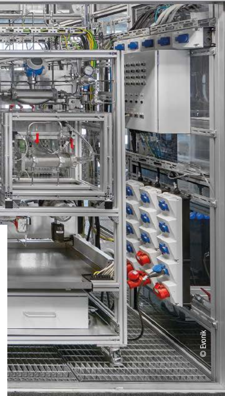
Modularer, flexibler Aufbau am Beispiel einer MF-Anlage im Miniplant-Maßstab
