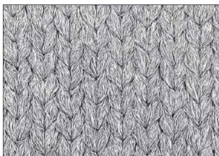
Abb. 7: Hochdichte Struktur eines gestrickten HiTech-Reinigungstuchs mit mehr als 1.000 Maschen/cm 2 .
