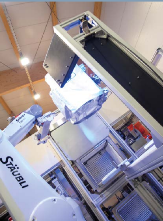
▲ Abb. 2: Der Roboter präsentiert die verpackte Box einem Bildverarbeitungssystem für die Qualitätskontrolle.
