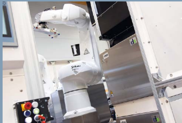
▲ Abb. 1: Zwei Staubli Sechssachsroboter vom Typ TX2-160 übernehmen sämtliche Handhabungsprozesse bei der FOSB-Verpackung.
