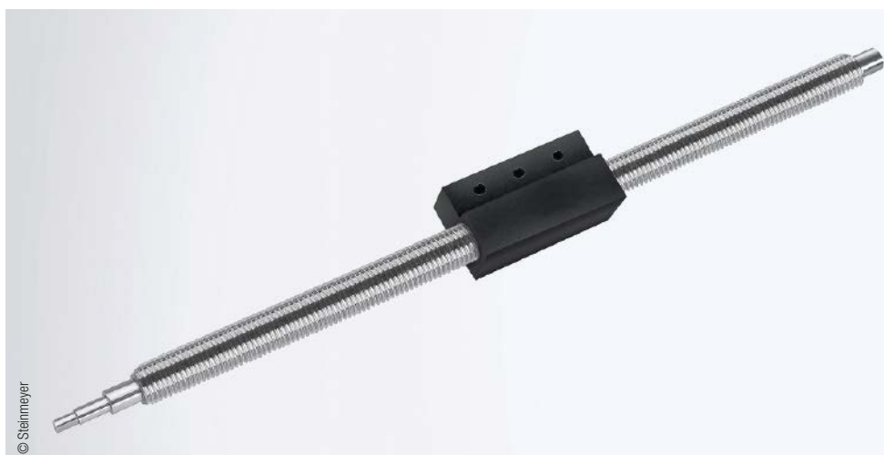
Abb. 2: Der Gleitgewindetrieb hat einen Spindeldurchmesser von 3 mm und eine Spindellänge von 112 mm und gehört damit zu den kleinsten am Markt in dieser Präzision
