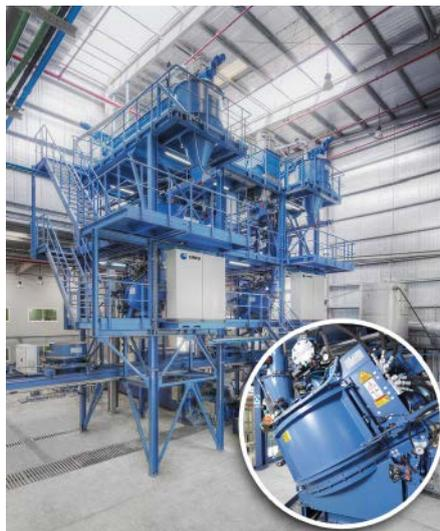
Evatherm-Anlage mit Vakuum-Verdampfungskühlung zum Einsatz für Schwefelsäure-Metalloxid-Reaktionen
