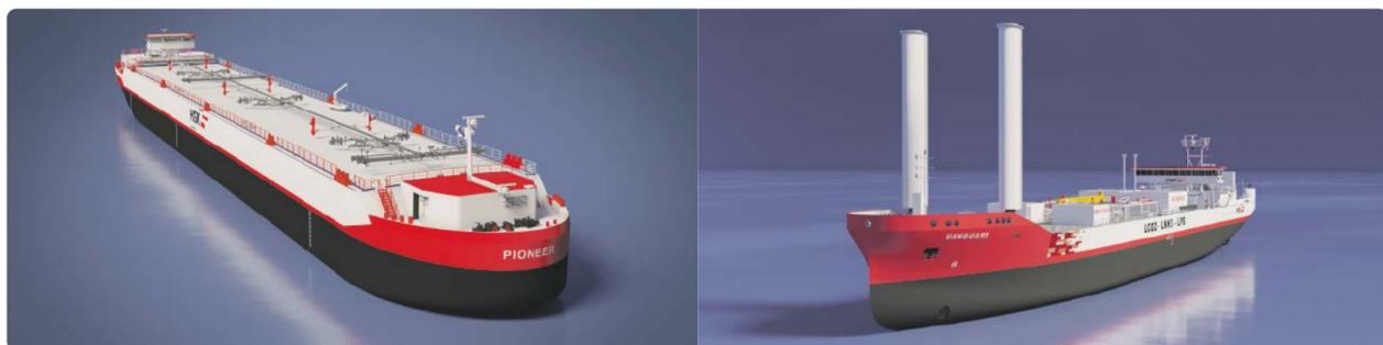
Die Projekte „Pioneer“ (links) und „Vanguard“ (rechts) können auf den Binnenwasserstraßen und in küstennahen Gewässern die unter Druck verflüssigten Wasserstoffderivate befördern.
