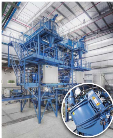
Evatherm-Anlage mit Vakuum-Verdampfungskühlung zum Einsatz für Schwefelsäure-Metalloxid-Reaktionen
