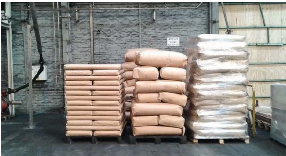
Die Verpackung mit dem Vakuumpacker Velovac (links) ermöglicht ein sauberes, deutlich stabileres Palettenbild, verglichen mit der Abpackung ohne Vakuum (rechts).
