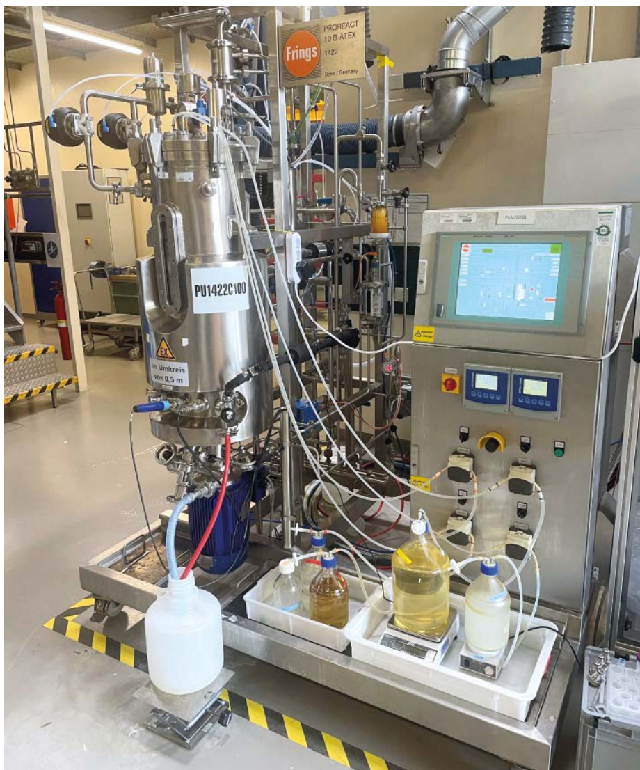
Geschlossener 50-Liter-Edelstahl-Bioreaktor zur Kultivierung der Purpurbakterien in einem größeren Maßstab.
