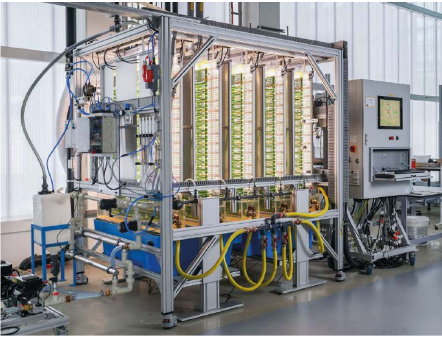
Das im Prozess von den Purpurbakterien gebildete Kohlenstoffdioxid wird der angekoppelten Mikroalgenanlage zugeführt.
