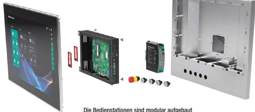
Die Bedienstationen sind modular aufgebaut und können individuell konfiguriert werden.
