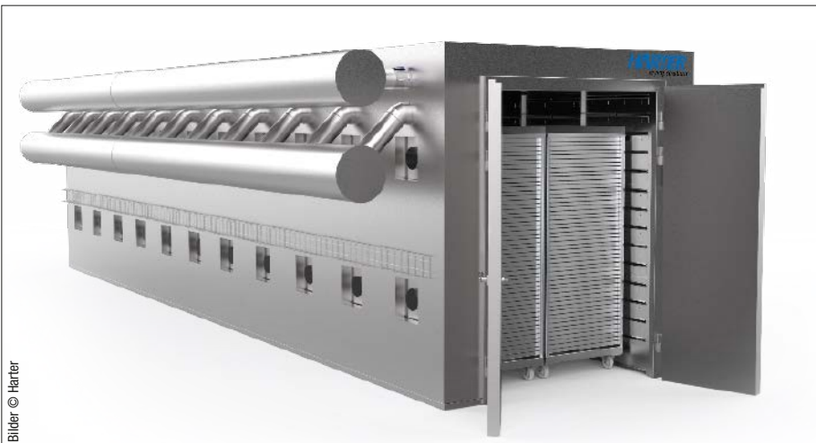
Der Trockner für die Pastillenproduktion besteht aus 11 Kammern und nimmt insgesamt 132 Palettengestelle auf. Die Nennleistung des Wärmepumpentrockner im Produktionsbetrieb liegt bei 33 kW.
