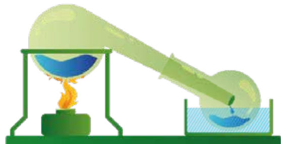
Über-Kopf-Destillation: Einfache Form der destillativen Trennung flüssiger Gemische.
