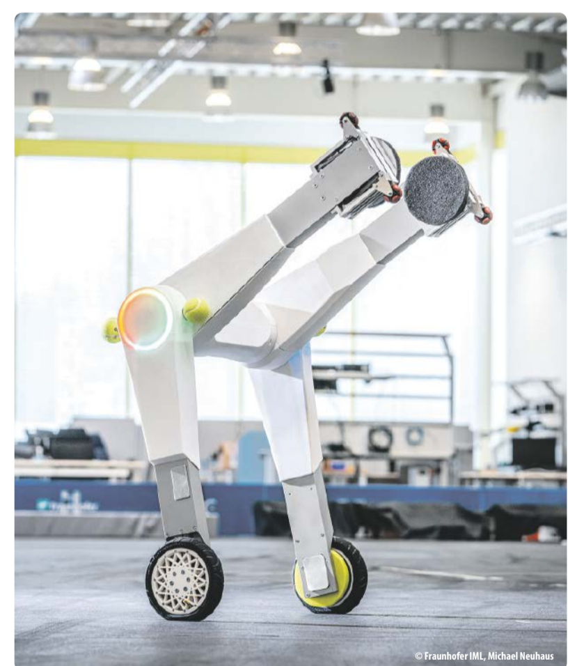
Der autonome kollaborative Roboter ‚Evobot‘ erledigt unterschiedlichste Hebe- und Transportaufgaben.
