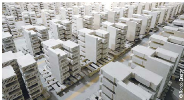
Die Wärme-Batterie speichert elektrische Energie mit Hilfe von Ziegelsteinen, die seit Jahrhunderten in Stahlwerken zur Wärmespeicherung eingesetzt werden.
