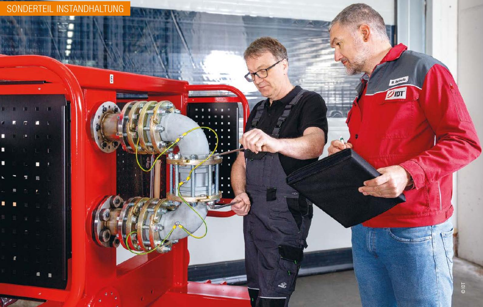
Die zertifizierte Flanschmontageschulung nach DIN EN 1591-4 gehört zum Leistungsangebot von IDT ebenso wie Qualifikationschecks gemäß Kundenvorgabe mit der individuell konfigurierbaren Flanschmontage-Station Flange.Pilot.
