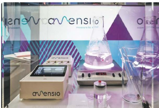
Mobile Sens-o-Spheres (in Schüttelkolben, Reagenzglas und Podest) mit Empfängereinheit Gateway (vorne links) und Ladegerät Charger (hinten links)
