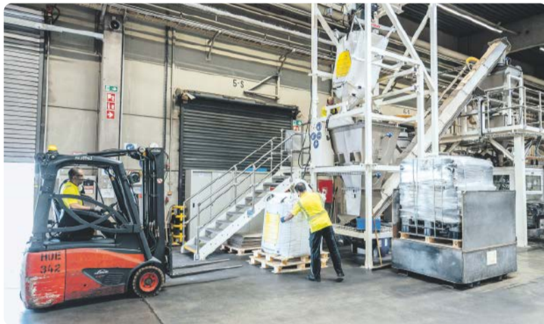
Über eine vollautomatische Abfüllanlage werden Ein-Tonnen-Bigbags in 25-Kilogramm-Säcke umgefüllt.
