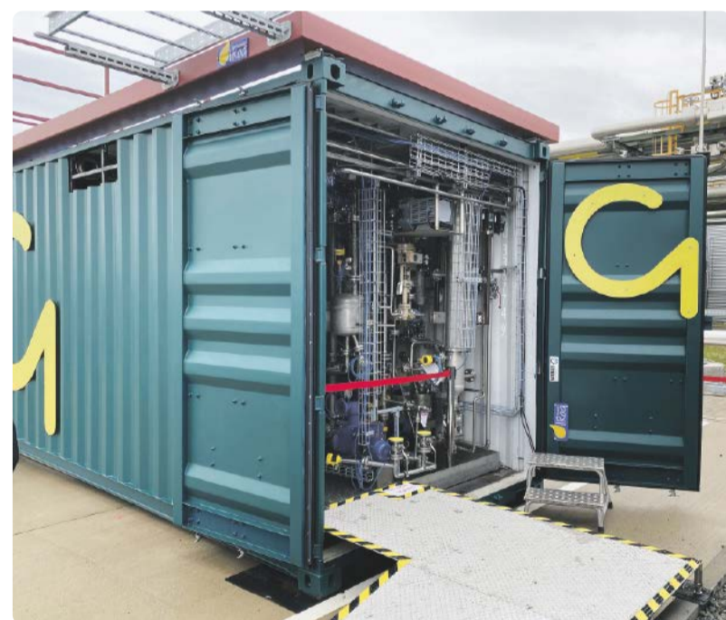
Pilotanlage zur Produktion von grünem Methanol
