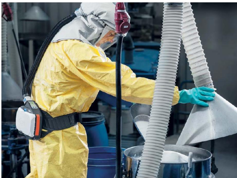
Bei Abfüll-, Umfüll- oder Mischarbeiten kann Kontakt mit Nanopartikeln entstehen. Gebläsefiltergeräte wie das Dräger X-plore 8700 bieten den geeigneten Atemschutz und sorgen in der richtigen Kombination mit einem Helm, einer Haube oder einem Visier für einen konstanten Luftstrom ohne Einatemwiderstände.
