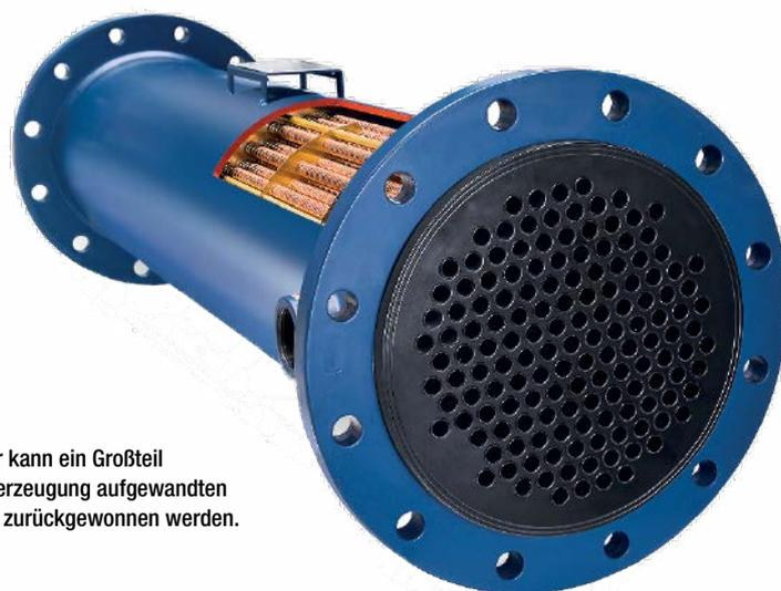
**Über Wärmetauscher kann ein Großteil der für die Druckluftherzeugung aufgewandten elektrischen Energie zurückgewonnen werden.**
