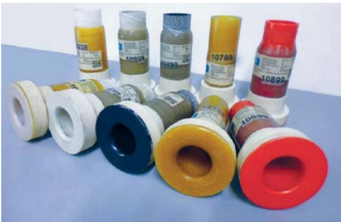
Abb. 2: Untersuchte GFK-Flanschbunde
