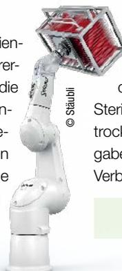
des Unternehmens sind bereits ein wichtiger Bestandteil von Abfüll- und Verpackungslinien, z.B. zum Be- und Entladen von Gefriertrocknern, wie den TX2-90 Stericlean+ Roboter, der Trays in einen Gefriertrockner einlegen kann und zusätzliche Aufgaben wie das Aufnehmen von Clips und das Verbinden der Trays untereinander übernimmt.
