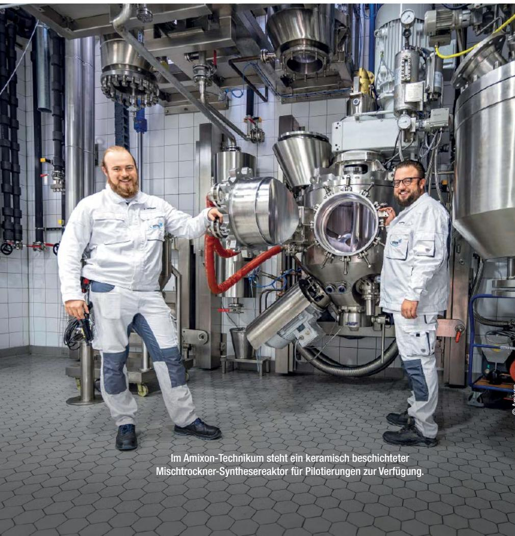
Im Amixon-Technikum steht ein keramisch beschichteter Mischrockner-Synthesereaktor für Pilotierungen zur Verfügung.
