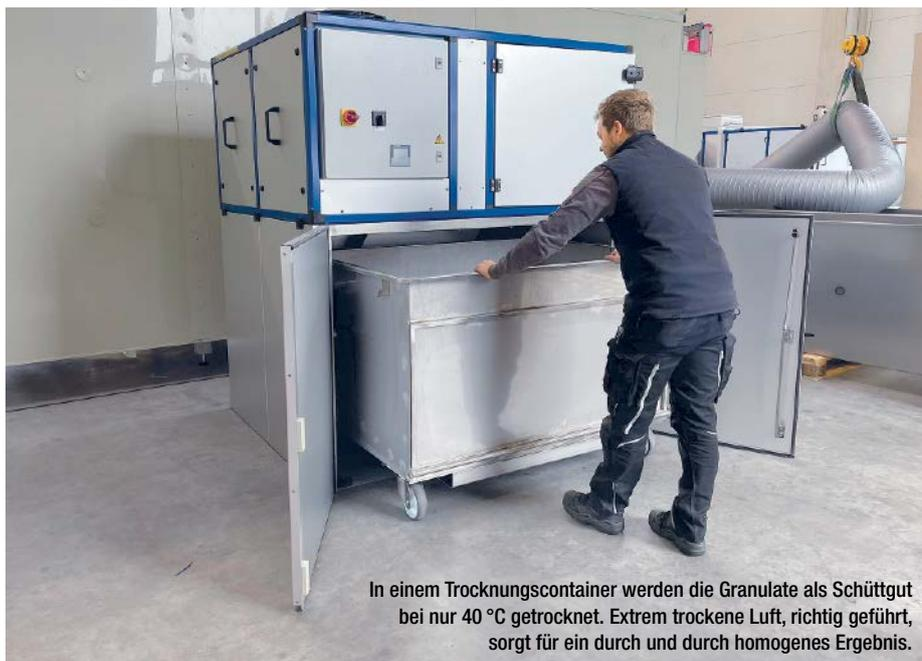
In einem Trocknungscontainer werden die Granulate als Schüttgut bei nur 40 °C getrocknet. Extrem trockene Luft, richtig geführt, sorgt für ein durch und durch homogenes Ergebnis.
