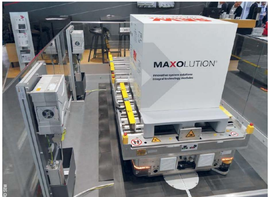
Dieses Fahrzeug aus dem Maxolution-Technologiebaukasten ist für den innerbetrieblichen Transport von Großladungsträgern wie Paletten und Gitterboxen vorgesehen. Zuverlässige, präzise und prozesssichere Lastübergabe in den Luftschleusen ist dank innovativer Navigations- und Sicherheitstechnologie von SEW-Eurodrive möglich.
