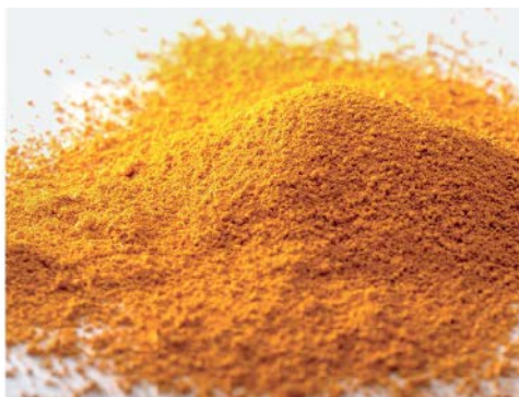
Partikelstruktur von Eisenoxid-Battery-Grades (FeO(OH), Goethit, zur Herstellung von LFP-Kathodenmaterial
