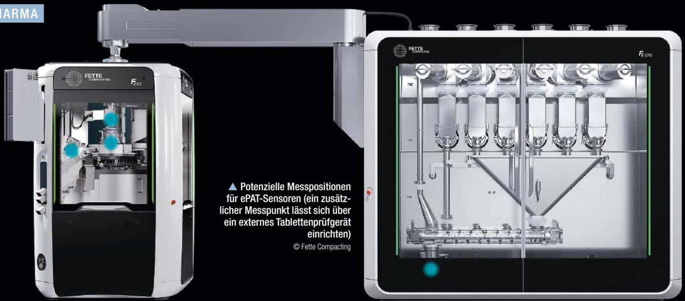
▲ Potenzielle Messpositionen für ePAT-Sensoren (ein zusätzlicher Messpunkt lässt sich über ein externes Tablettenprüfgerät einrichten)
