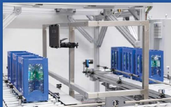
Abb. 3: Jedes EMS-Element besteht inklusive Spannverbinder aus Edelstahlguss
