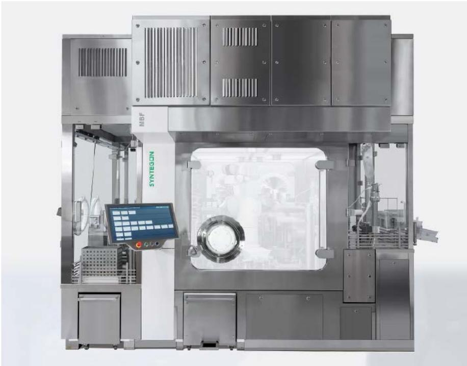
◀ **Abb. 2:** Die vollautomatisierte, handschuhlose Produktionszelle Versynta microBatch von Syntegon befüllt zwischen 120 und 500 Behältnisse pro Stunde nahezu ohne Produktverlust.
