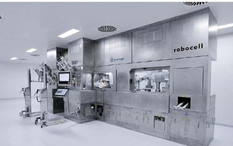
◀ Robocell ist eine vollautomatisierte aseptische Füll-Linie mittels Roboter-technik.
