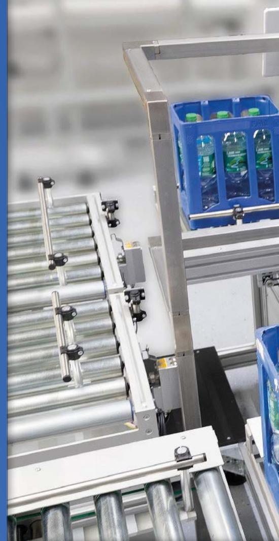
die Anschlussrohre geschoben und über das Anziehen einer Schraube fest gespannt werden. Auf diese Weise entsteht eine sichere und dennoch jederzeit wieder lösbare Verbindung. Die spezielle Spanntechnik, die Toleranzen bis zu 2 mm kompensieren kann, sorgt sowohl im Rund- als auch im Vierkantrohr für einen sicheren Vierpunkt-Kontakt.
