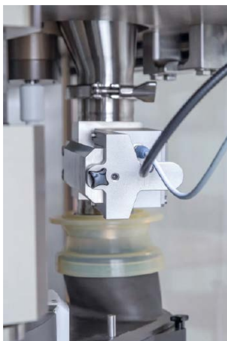
▲ Abb. 2: Beispielhafter ePAT-Messkopf (integrierter Nahinfrarotsensor im Füllrohr einer Rundläufer-Tablettenpresse) © Fette Compacting
