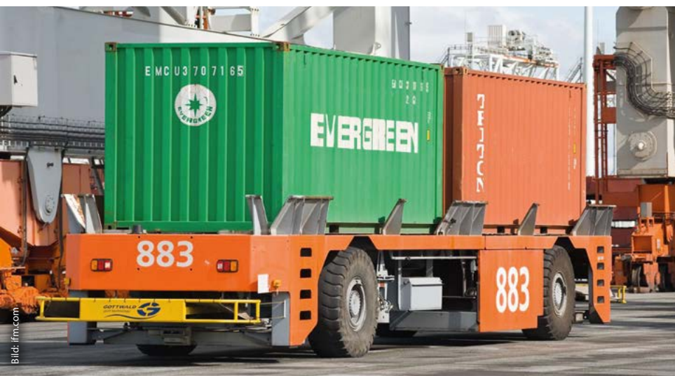
Automatisierter Containertransport mit IO-Link-Sensoren und Mobilfunk auf einem AGV.
