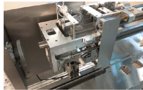
Abb. 1: Trockentribologieprüfstand – Partikelemissionsverhalten unter atmosphärischen und feuchtigkeitsreduzierten Bedingungen.
