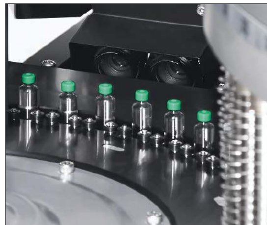
Die Kappen der Karpulen werden mit Kameras geprüft, wie hier an der Station für die seitliche Kappeninspektion einer Syntegon AIM 2023C.
