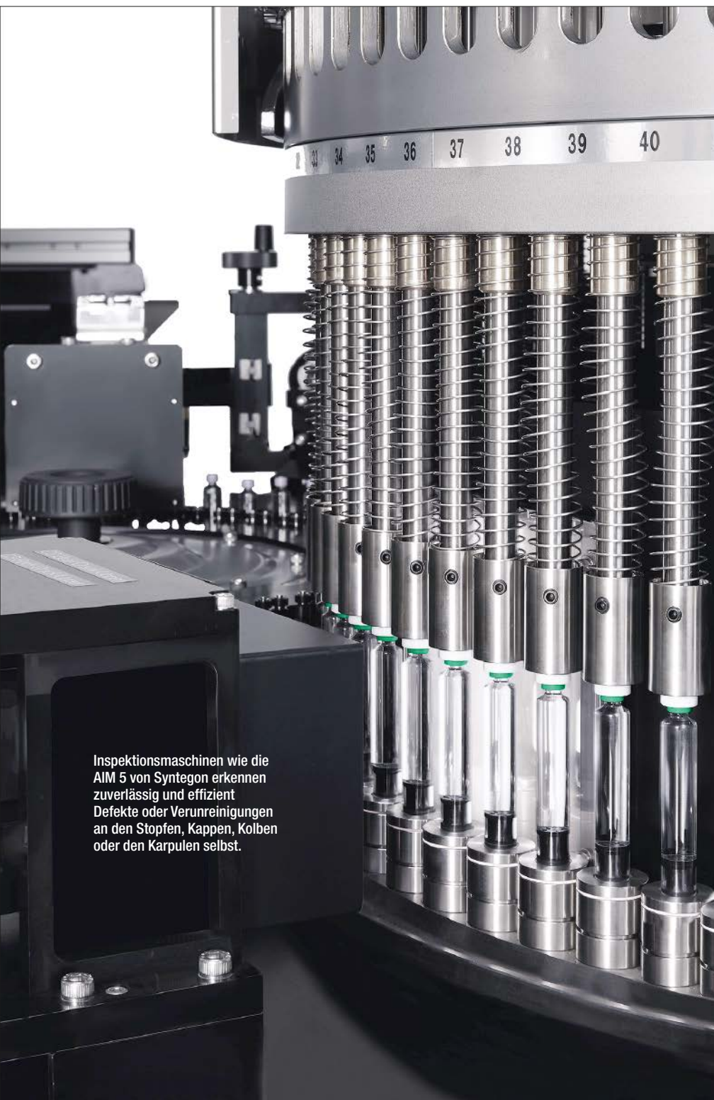
Die Kappen der Karpulen werden mit Kameras geprüft, wie hier an der Station für die seitliche Kappeninspektion einer Syntegon AIM 2023C.
