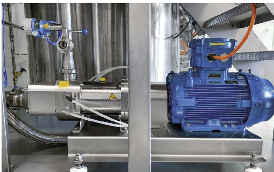
Jede Pumpengröße kann mit zwei verschiedenen Schrauben montiert werden, jede mit einer bestimmten Steigung. Der freie Kugeldurchgang beträgt je nach Typ bis zu 30 mm und erlaubt, Medien mit großen Viskositätsunterschieden zu fördern. Die bei Steinfels Swiss geforderte Viskositätsbandbreite von 1 bis 6.000 mPa wird von der installierten Pumpe problemlos abgedeckt.
