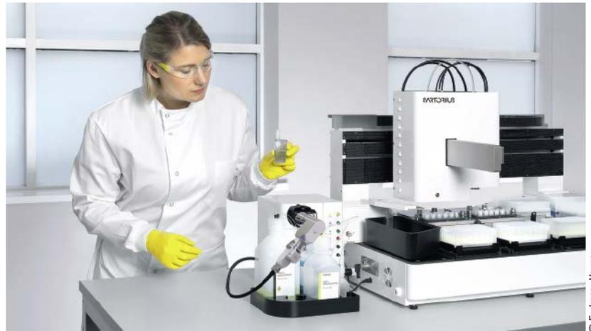
Die Rxn-46 Sonde an einem Sartorius BioPAT Spectrometer für einen Ambr 15 and Ambr 250 High Throughput-Reaktor.
