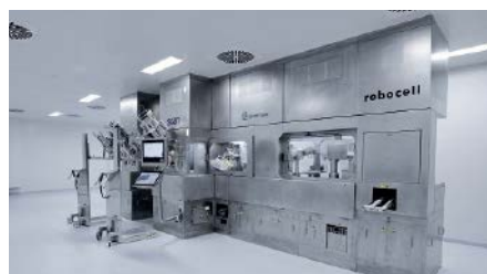
▲ Robocell ist eine vollautomatisierte aseptische Füll-Linie mittels Robotertechnik.
