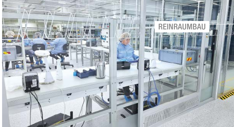
Abb. 2: Vollverglaste Umluftwände sorgen für Tageslicht und Einsicht bei der Herstellung der Endoskope
