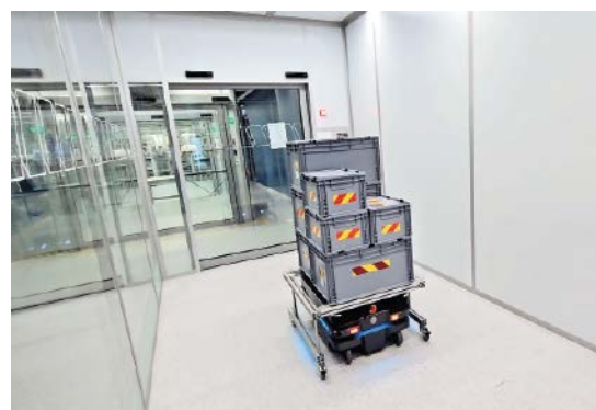
Abb. 4: Autonome mobile Roboter, die per Funk die Schiebetüren öffnen, fahren automatisch in die Materialschleuse ein
