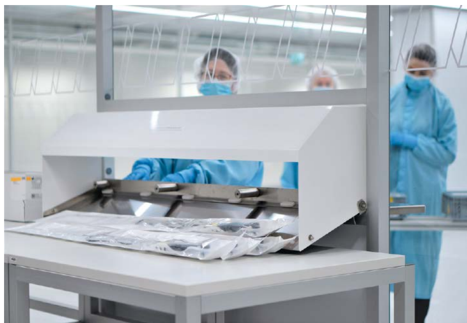
Abb. 3: Die Einweg-Endoskope werden sicher verpackt und aus dem Reinraum geschleust
