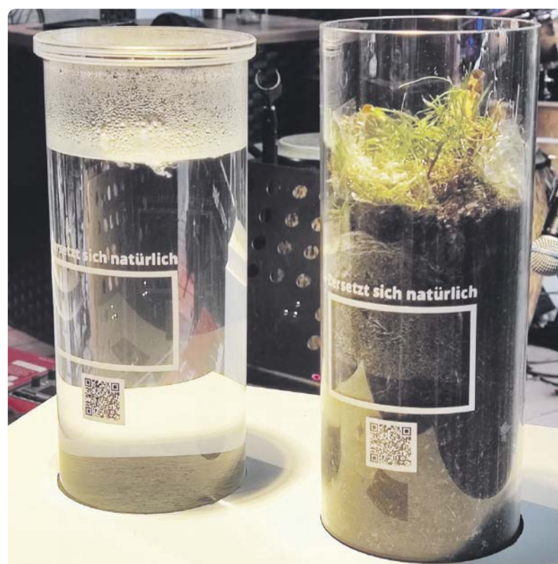
Cell2Green entwickelt hauchdünne Folien aus Cellulose, die innerhalb von zehn Tagen im Boden (l.) bzw. zwei bis drei Monaten im Wasser (r.) abgebaut werden.
