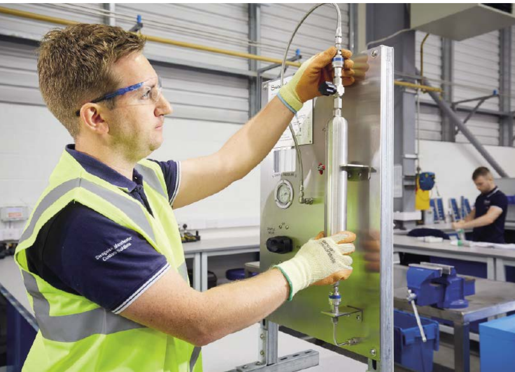
Bei der Stichprobenahme kommen zur Entnahme druckbeaufschlagter Gase oder Flüssigkeiten in der Regel Zylinder zum Einsatz.
