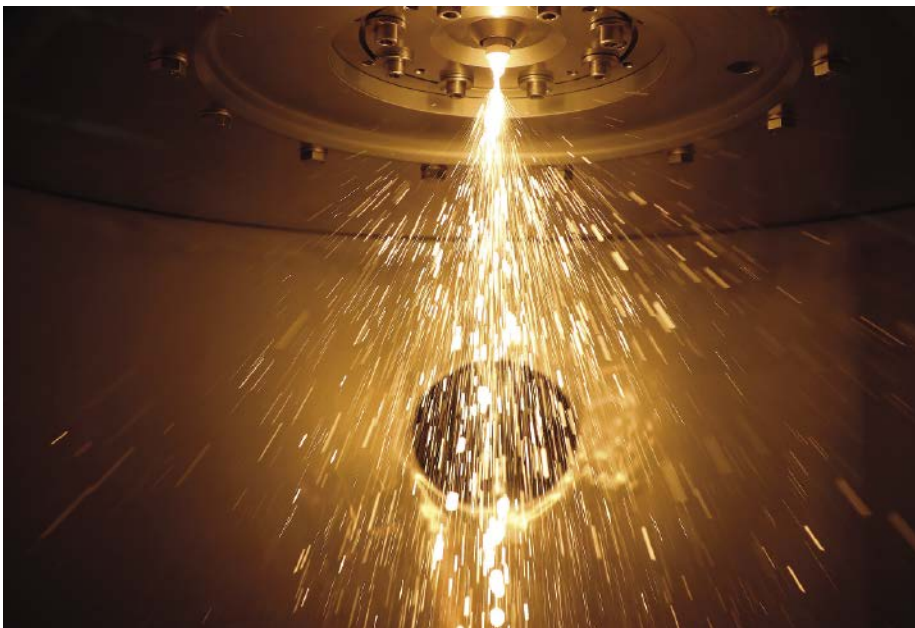
Beim Verdüsen zerstäubt geschmolzenes Metall zu Tröpfchen, die anschließend zu Pulverpartikeln erstarren.
