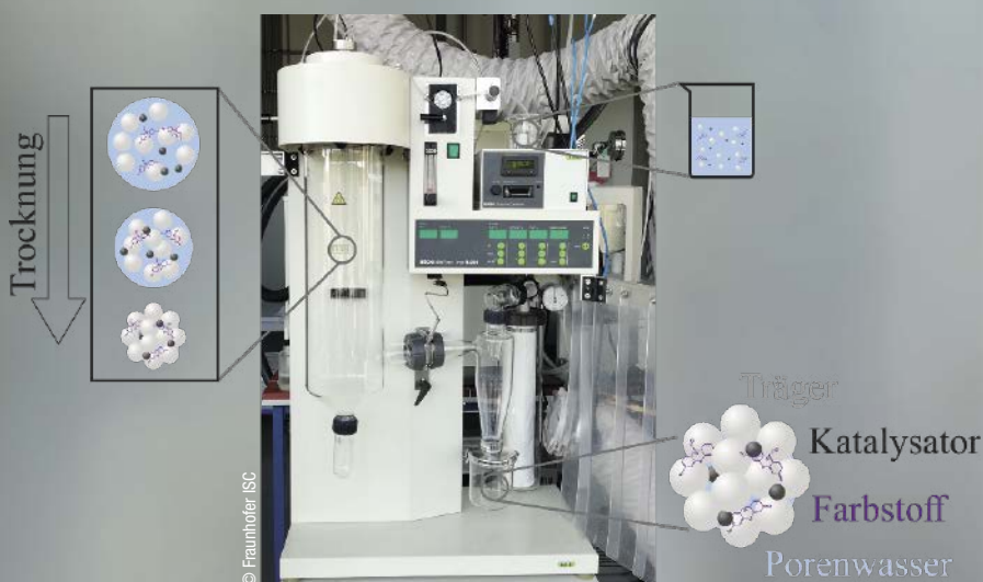
Abb. 3: Zum Einsatz kommt der Laborsprühtrockner Büchi B290. Schematische dargestellt ist die Speise, der Trocknungseffekt, sowie die Zusammensetzung des resultierenden Wasserstoff-Indikator-Suprapartikels
