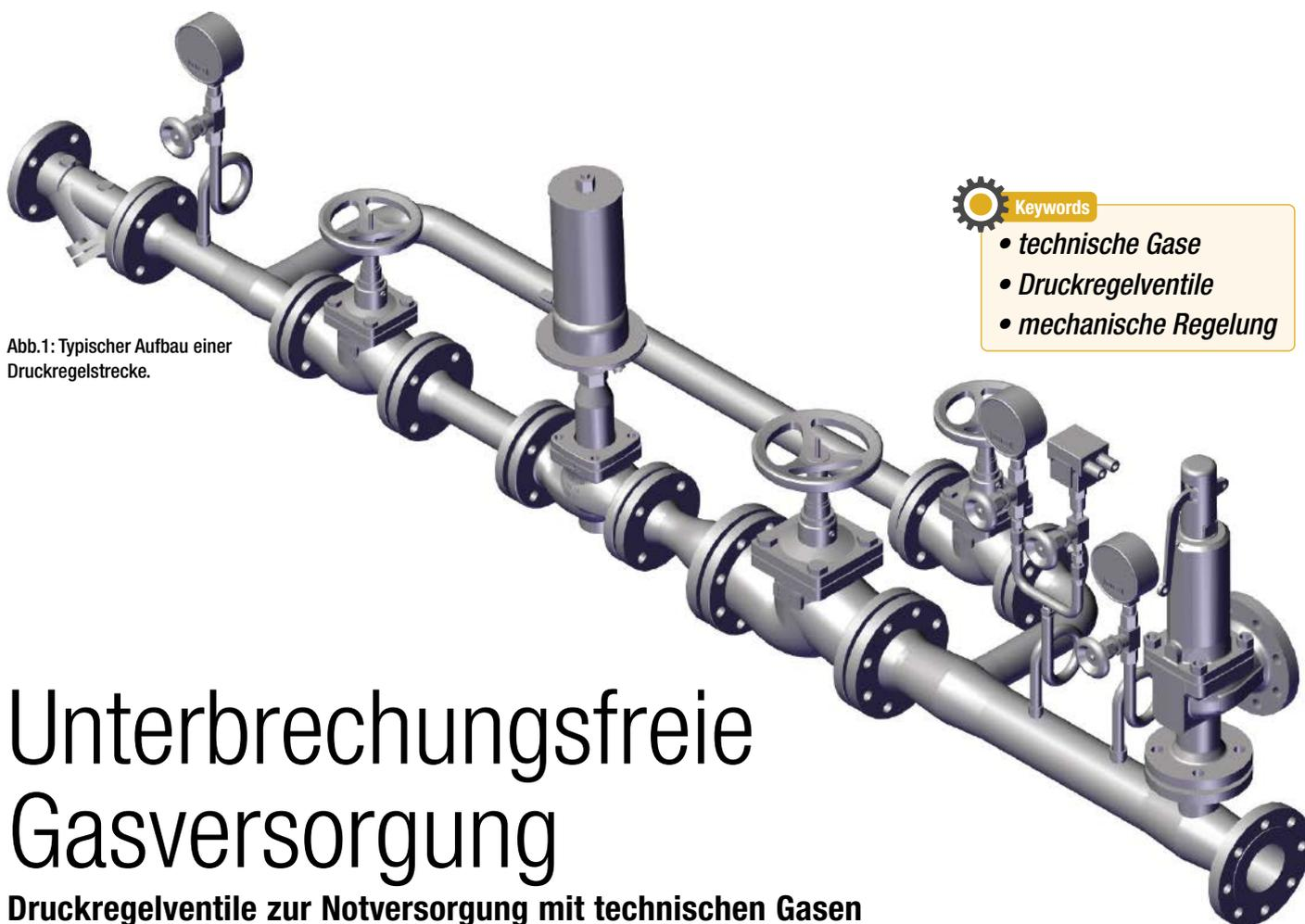
Abb.1: Typischer Aufbau einer Druckregelstrecke.
