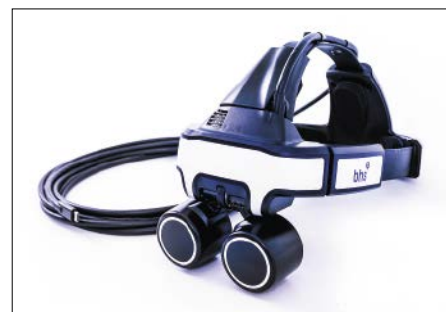
Abb. 5: Über das Head Mounted Display kann der Operateur die Kamerabewegung per Kopfbewegung steuern und hat gleichzeitig beide Hände frei.
