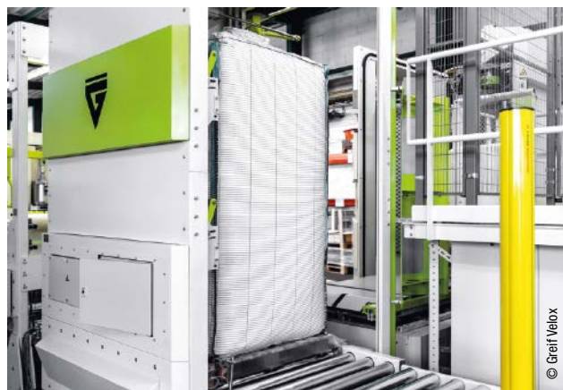
Staubfreies Absacken von ultraleichten Pulvern in FIBCs (Big Bags) mit dem Greif-Velox Velovac XL.
