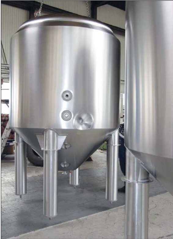
◀ Abb. 4: Je nach Kundenanforderung ergänzen Heiz- und Kühlmantel, Rührwerk und CIP-Anschluss die Behälterkonstruktion aus Edelstahl Rostfrei.
