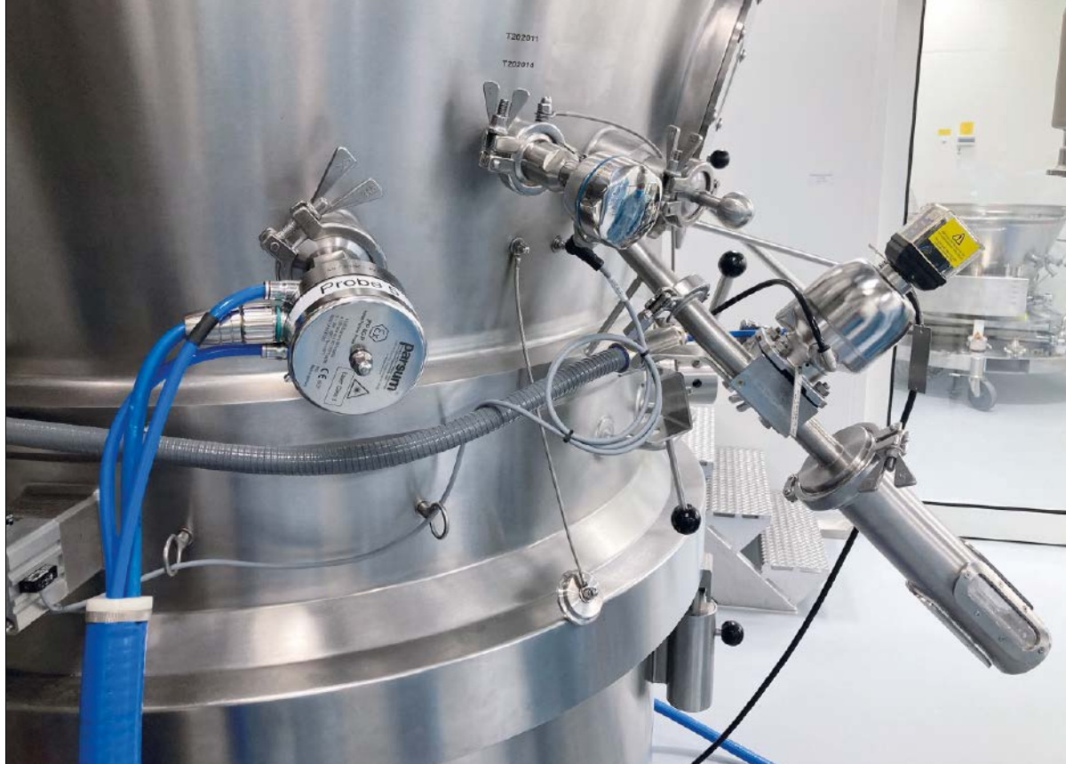
Anwendung der Parsum-Sonde an einem Wirbelschichtgranulator.
