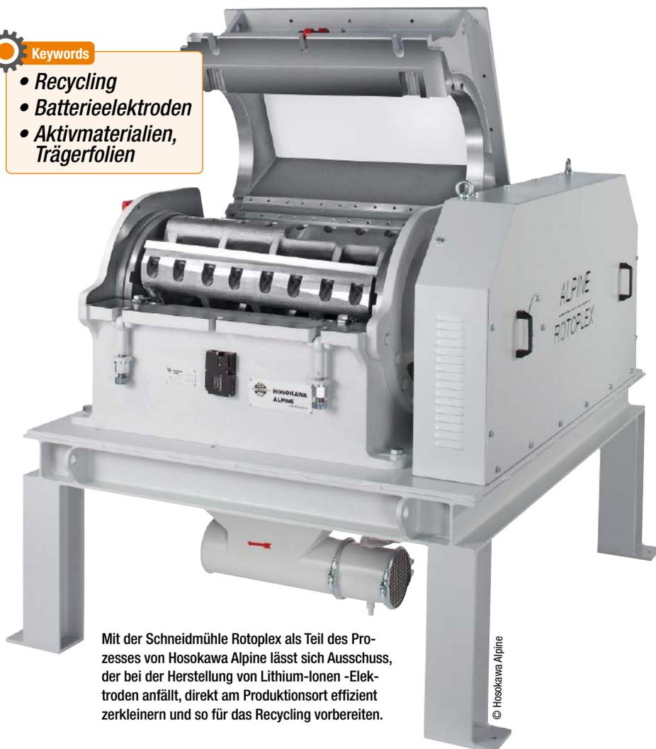
Mit der Schneidmühle Rotoplex als Teil des Prozesses von Hosokawa Alpine lässt sich Ausschuss, der bei der Herstellung von Lithium-Ionen-Elektroden anfällt, direkt am Produktionsort effizient zerkleinern und so für das Recycling vorbereiten.
