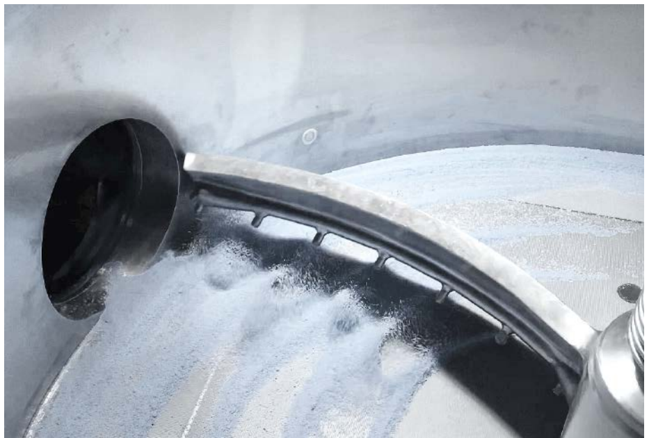
Die kleine Düsen auf dem Gas Knife-Rührflügel blasen das Pulver zum Seitenaustragsventil, so dass der Behälter schnell und vollständig, mit einer Entladungseffizienz von bis zu 99 % entleert wird.
