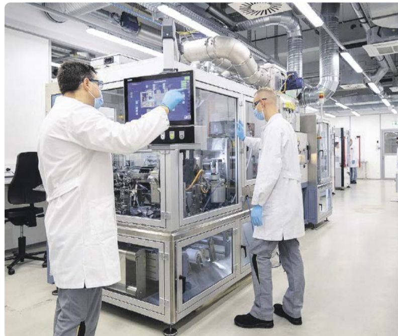
Im Forschungs- & Entwicklungszentrum in Bruchsal stellt Innolith im Labormaßstab Elektrolyt her, mit dem anschließend Musterzellen gefertigt werden.
