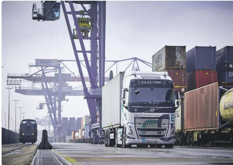
weit eine CO<sub>2</sub>e-reduzierte Transportkette anzubieten. Diese bildet den Containerverkehr mit E-Lkw und ökostrombetriebenen Bahnen ab.“ Der Volvo FH Electric hat ein zulässiges Gesamtgewicht von 44 t. Mit sechs Batteriepaketen von je 90 kWh wird ein 490 kW starker Synchronmotor angetrieben. Bei einer Gesamtkapazität von 540 kWh hat der E-Volvo je nach Gewicht der
