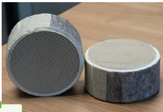
Keramikteile Katalysator mit Vliesumrandung
