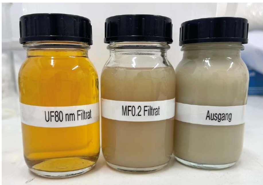
Abb. 1: Ergebnis der Filtration eines wasseremulgierbaren Kühlschmierstoffes
