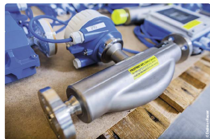
In den Ethernet-APL Lasttest waren fast 240 Messgeräte von Endress+Hauser integriert, darunter Durchfluss-, Druck-, Temperatur- und Füllstandssensoren.
