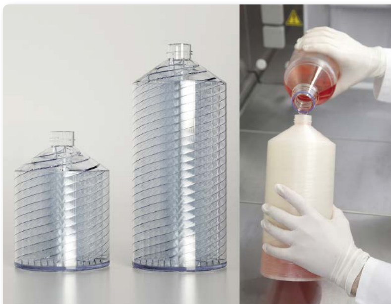
Die CellScrew gibt es in zwei Größen mit verschiedenen Wachstumsoberflächen (6K: 6.000 cm 2 und 10K: 10.000 cm 2 ). Medium wird von oben durch einen zylindrischen Kanal eingefüllt und durch Rotation der archimedischen Schrauben wieder nach oben transportiert.
