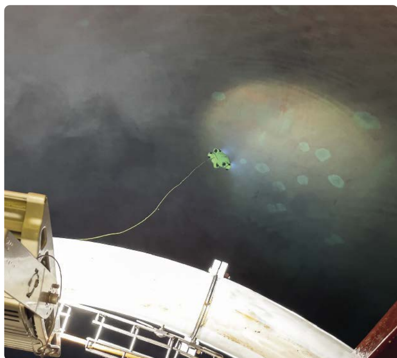
In den Kühlbecken werden Geräte mit einer Reichweite von bis zu 100 m genutzt.
