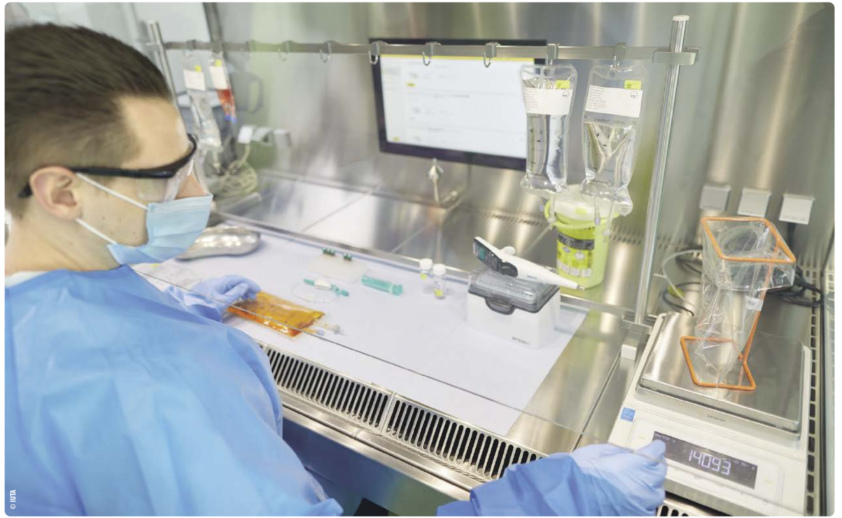
Digitalisierter Workflow für die Qualitätskontrolle von patientenindividuellen Zytostatika-Zubereitungen. Der im Vollschutz an der Sicherheitswerkbank tätige Mitarbeitende wird durch Betätigung der Waagentaste vollautomatisiert durch den Workflow geleitet. Die zweite Person, die bei der analogen Datenerfassung für die Dokumentation der Wägeregebnisse benötigt wurde, kann nun höherwertige Tätigkeiten durchführen.
