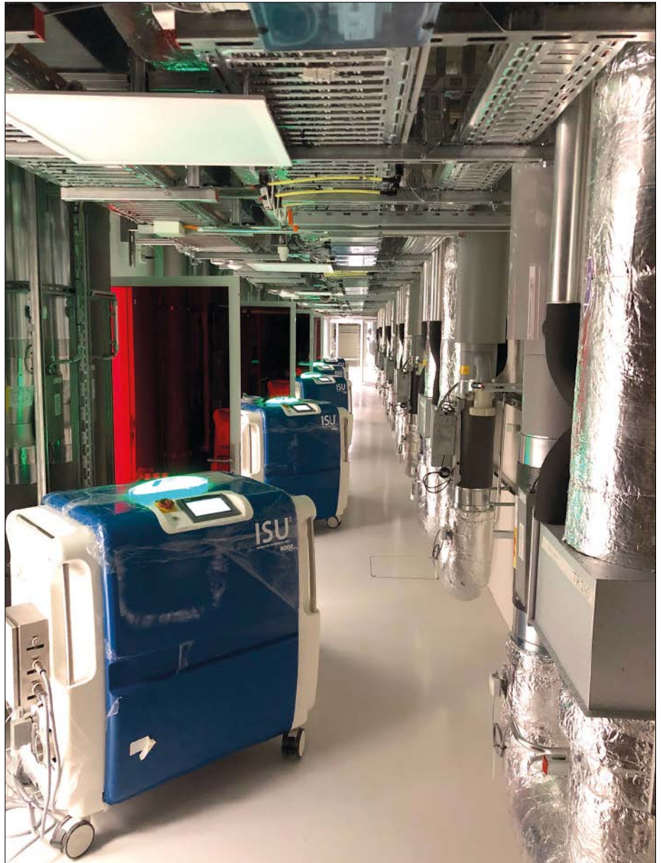
Abb. 14: H 2 O 2 Generatoren im Verbund
