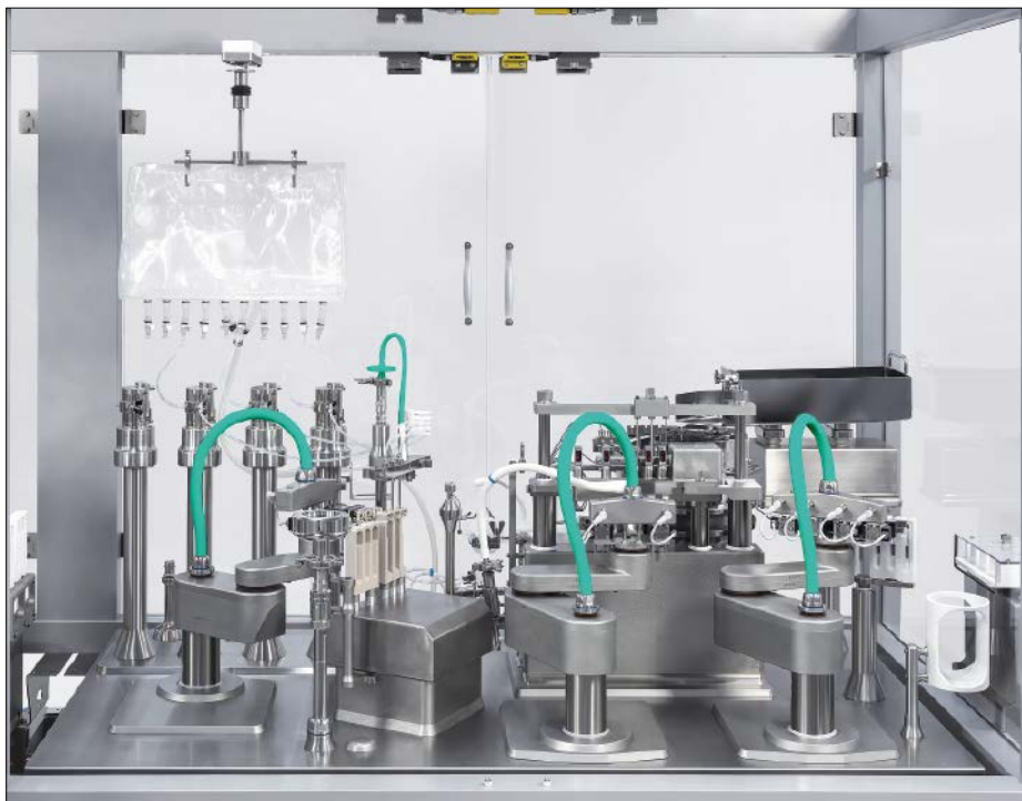
Abb. 2: Versynta FFP lässt sich problemlos auf verschiedene Behältnisarten wie Vials, Spritzen und Karpulen sowie unterschiedliche Abfüllsysteme inklusive Einweg-Lösungen umrüsten
