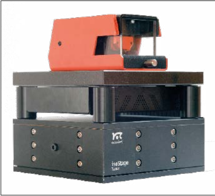
Abb. 8: Atomkraft-Mikroskop zur Darstellung von Nano-Strukturen wie Oberflächen-Verletzungen (siehe Vortrags-Publikation Nr. 31 Win Labuda).
