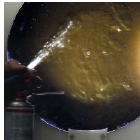
Abb. 5: Ausströmendes Kaltgas aus einem Ballon. Deutlich erkennbar die Schlieren die nach unten wandern.
