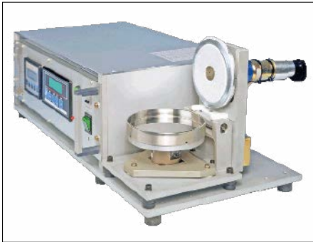
Abb. 4: Schalenmethode nach Labuda, Rotations-Wischsimulator Mark II nach Labuda/Schöttle zur Bestimmung des effektiven Partikel-Abriebs.
