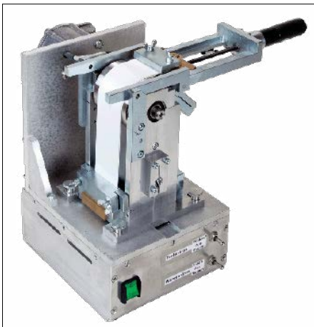
Abb. 5: Rotations-Wischsimulator Mark III nach Labuda/Schöttle zur Bestimmung der Reinigungs-Effektivität von verschiedenen Wischmitteln.
