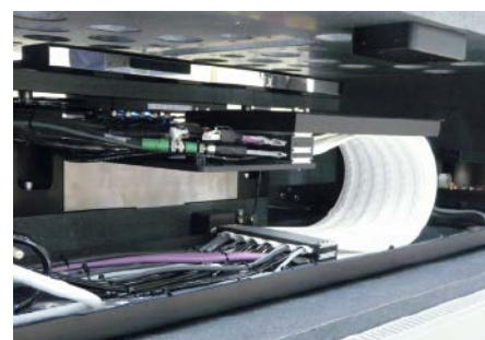
Abb. 4: Heidelberg Instruments nutzt die e-skin flat an den y-Achsen des Kreuztisches einiger Anlagentypen.
